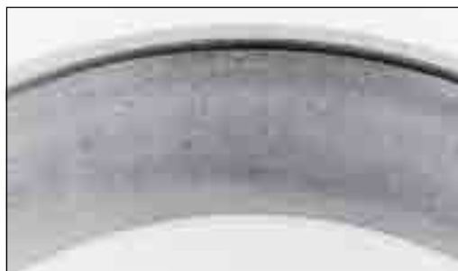
图 181. 由其他疲劳零件、密封松动或维护不当所产生的碎屑导致圆锥滚子轴承的滚道擦伤。
