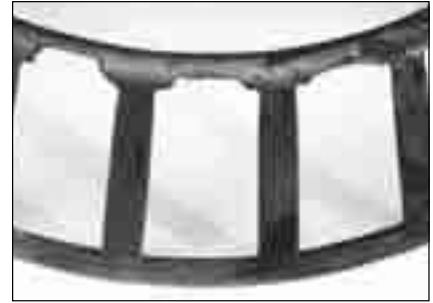
图 208. 保持架兜孔小端过度磨损是典型的游隙过大的标志。
