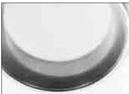
图 210. 变形，加工不精确或者磨损的轴承贴合面导致这个圆锥轴承外圈滚道上不规则的滚子磨损痕迹。
