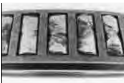
图 204. 圆锥滚子轴承的严重过载导致滚子出现过早的严重疲劳剥落。负荷过重，使滚子上的金属大片脱落。
