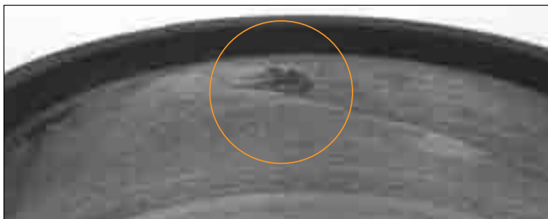
图 225. 由于安装在金属杂质或拱起的金属刻痕上，球轴承的内圈发生破裂。
