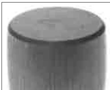
图 235. 轴承旋转时，因焊接而在调心滚子轴承上造成的电弧凹槽。
