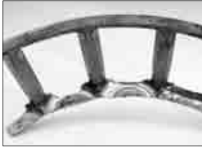
图 207. 滚子过度运动导致保持架兜孔损伤。
