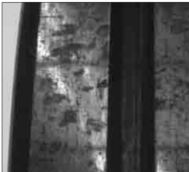
图 220. 由于轴承座磨损，导致该轴承在运行过程中配合松动，产生磨损。结果调心滚子轴承外圈出现金属撕裂和磨损。
