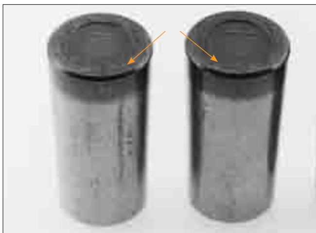
图 194. 三级—金属间接触导致圆锥滚子的热损伤。
