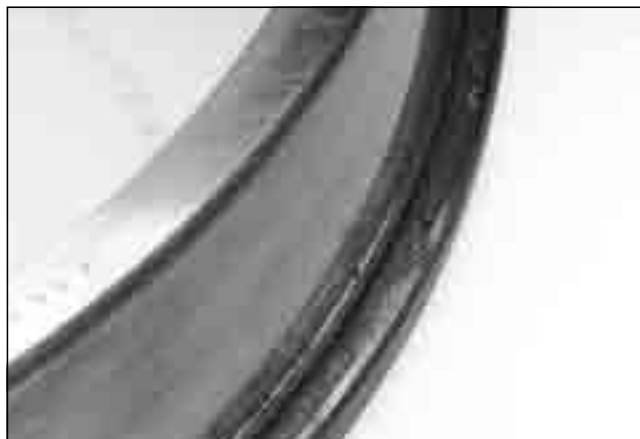
图 193. 二级-不足的润滑油膜导致严重的挡边擦伤。
