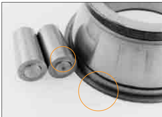
图 177. 微粒污染物造成圆锥滚子轴承磨损。
