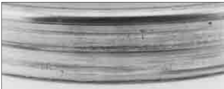
图 224. 旋转轮毂的外圈采取松配合（应该是紧配合），结果使轴承滚道损伤。
