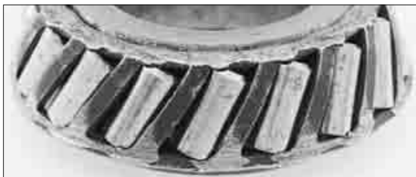
图 218. 圆锥滚子受卡成歪斜状，原因是在安装过程中保持架受到挤压，或是运行中有干涉。
