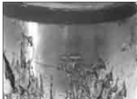
图 199. 图中的调心滚子轴承由于高负荷而产生了严重剥落和破裂
