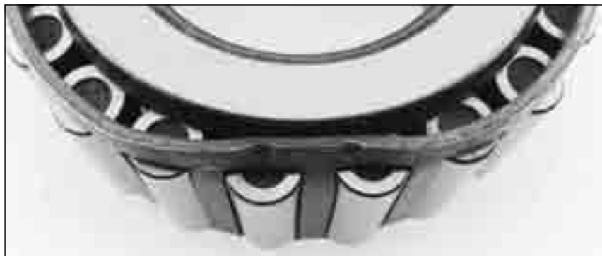
图 217. 保持架因安装不当或因轴承跌落而变形。
