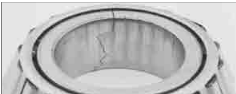
图 226. 失圆或轴径过大导致圆锥滚子轴承的内圈发生破裂。
