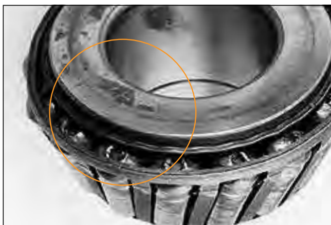
图 195. 四级—过热导致滚子上严重的金属流动以及内圈挡边的变形和保持架的扩张。
