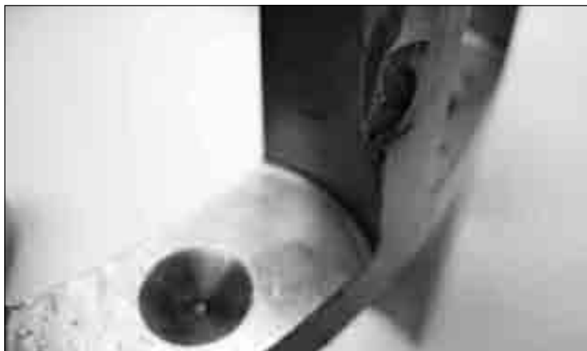
图 219. 操作严重不当使该调心滚子轴承保持架的梁上产生深度压痕。该损伤将导致滚子滚动不畅并出现打滑，温度升高，使用寿命缩短。
