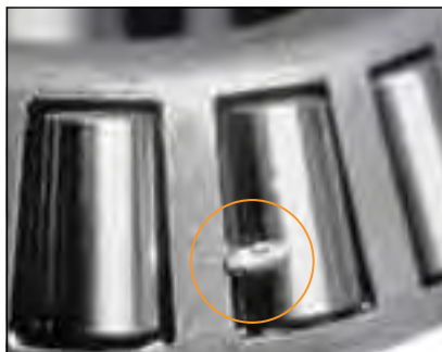
图 184. 大颗粒污染物嵌入软质保持架材料，导致槽痕。
