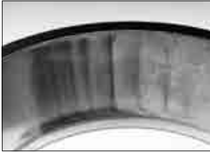
图 206. 游隙过大时经常会在外圈滚道上发现贝壳纹。这是由于松动的滚子进入小的负载区时突然承受巨大载荷造成的。
