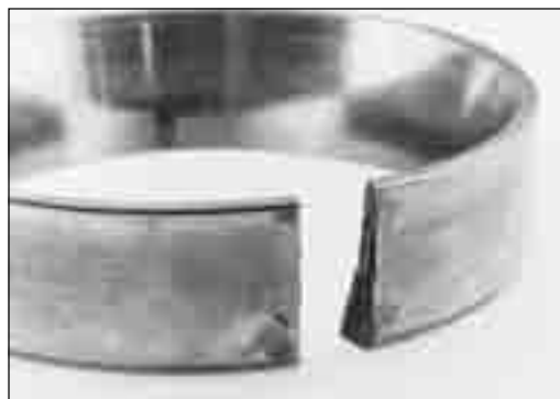
图 227. 这就是在轮毂里发生松动的外圈。外圈转动使轴承座磨损产生更大的间隙，外圈开始拉伸或铺开，此时仍然继续磨损轴承座，外圈继续拉伸，这个过程一直持续直达到达金属的断裂极限从而外圈裂开。
