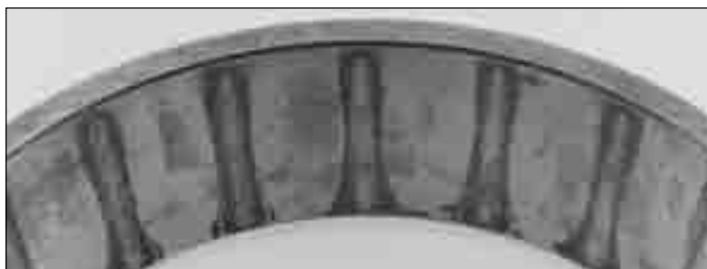
图 186. 图中外圈滚道呈现严重腐蚀。这种类型的腐蚀可能只是表面锈斑，而非点蚀。如果用细金刚砂布或磨粉布可以将污点清理干净，则轴承可再次使用。但如果存在麻点，而且用轻度抛光也清除不掉，则应当弃用；或者如果可行，将其重新打磨。
