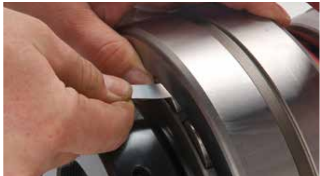
图 30. 安装前 RIC 测量
