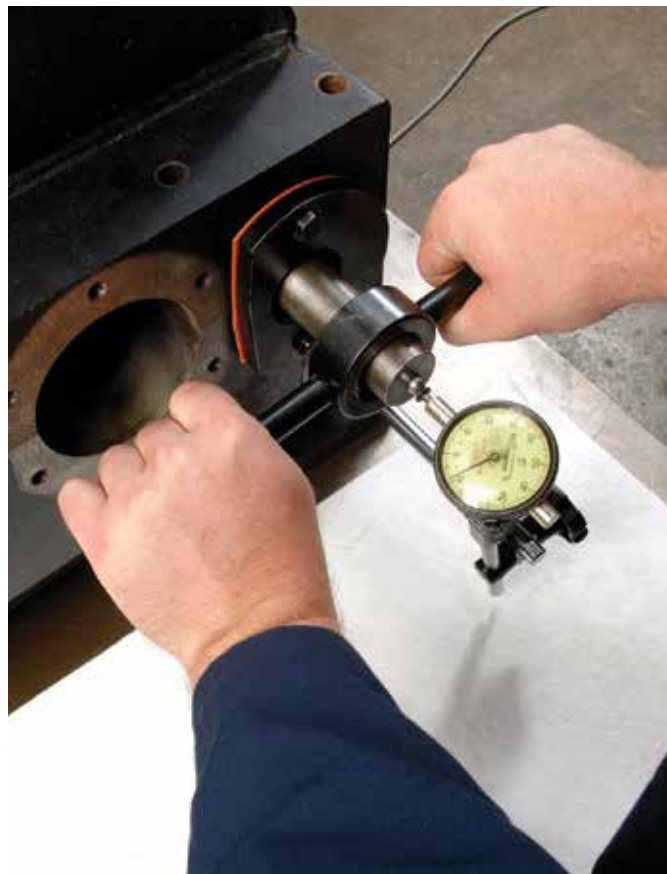
图 27. 在轴端装上百分表测量轴向窜动
