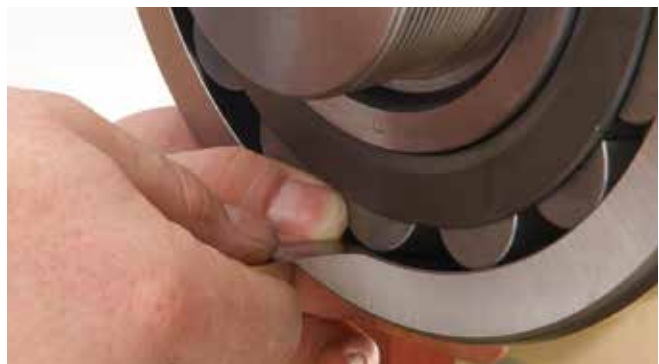
图 31. 安装过程中，检查无载荷滚子的 RIC
