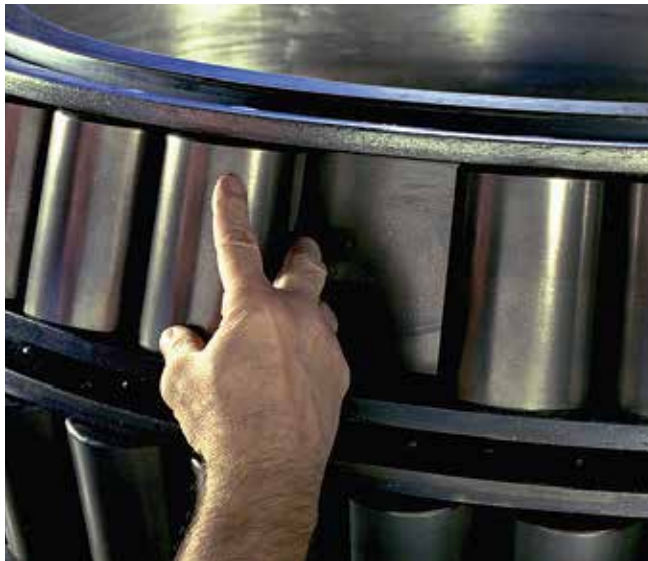
图 20. 在返回使用前必须检查轴承
