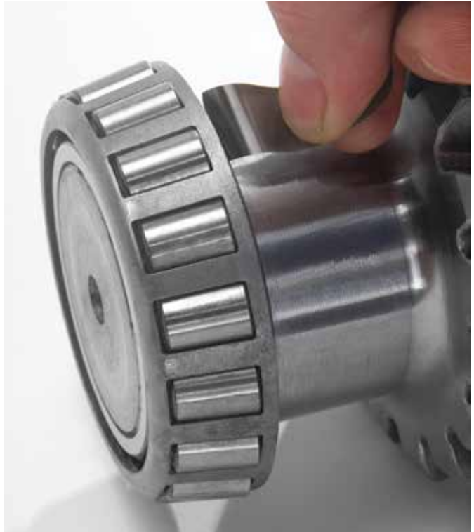
图 23. 使用塞尺检查轴承来确保其正确安装
