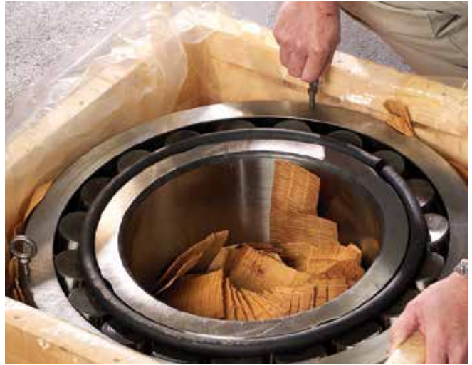
图 2. 吊环螺栓可以拧入吊装孔中
